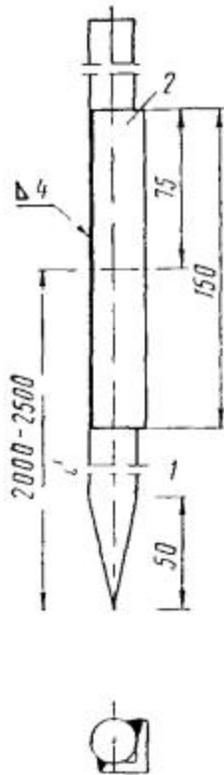
Рис. 3.12. Сварка секций глубинных заземлителей с помощью отрезка уголка
