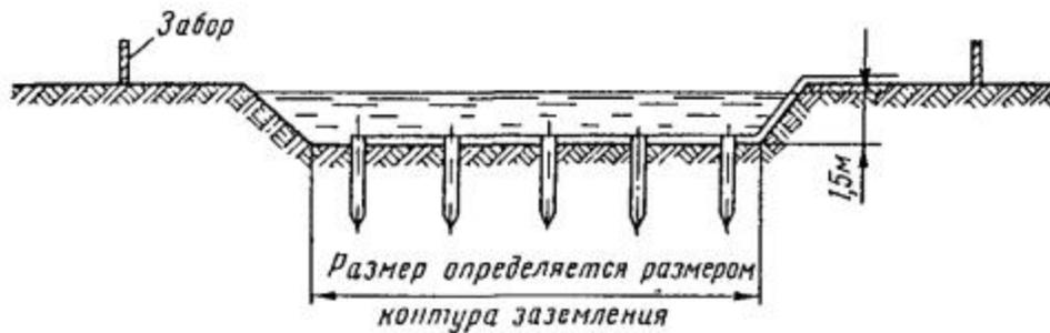
Рис. 7.1. Устройство контура заземления на дне пруда
